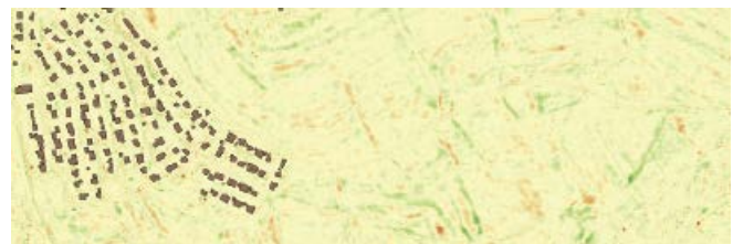
Abb. 1: Die Differenz aus trianguliertem Modellnetz und dem Geländemodell als 1 x 1 m Raster macht Kleinstrukturen sichtbar, die bei der Ausdünnung nicht berücksichtigt werden. Gelbe Bereiche zeigen geringe bis keine Differenzen, Rot und Grün dementspre-chend negative bzw. positive Abweichungen von der triangulier-ten Oberfläche im Dezimeterbereich
